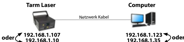
Die Tarm four und Tarm seven Showlaser haben standardmäßig die IP Adresse 192.168.1.107 eingestellt. Um die Verbindung herzustellen und die IP Adresse zu konfigurieren, muss das Lasersystem über ein Ethernet-Kabel direkt mit dem Laptop oder PC verbunden werden.
